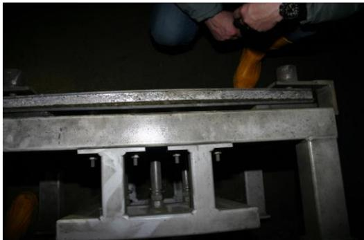
Deformazione din. del campione di prova: <math><25\text{ mm}</math>
