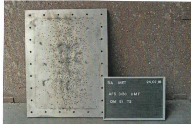
*lato anteriore del campione di prova dopo l'esplosione*
